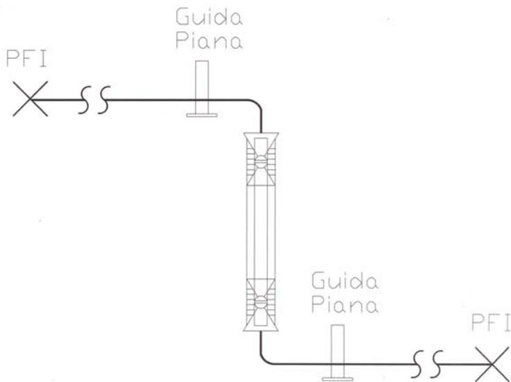
SPHERICAL LATERAL EXPANSION JOINT:
